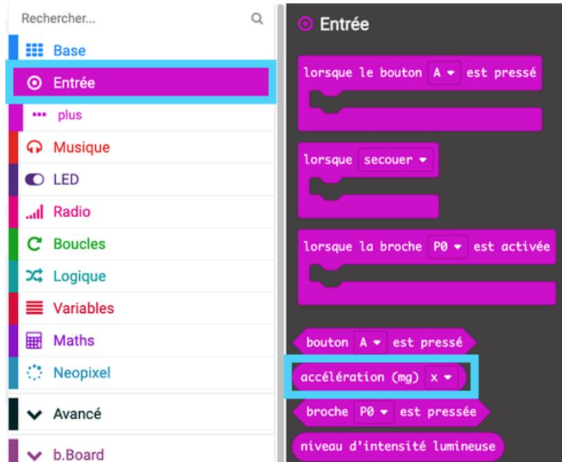
Déposez le bloc accélération (mg) dans le bloc « montrer nombre » à l'intérieur de votre bloc de base «toujours » et changez l'accélération de « x » à « force ». Cela nous permet de mesurer la force des vibrations/accélérations dans n'importe quelle direction au lieu d'une seule.
